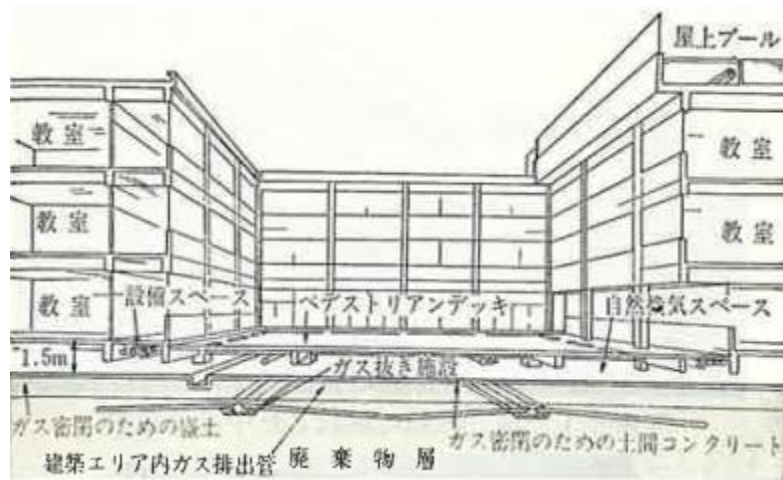
図6 学校建設における対策事例(福岡市)
