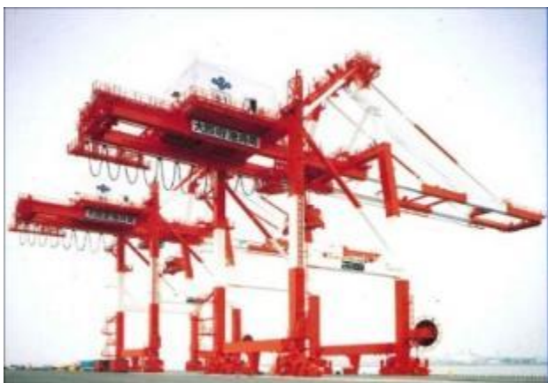
ガントリークレーン
