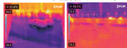
【床面のサーモカメラ写真（左：夏期、右：冬期）】
