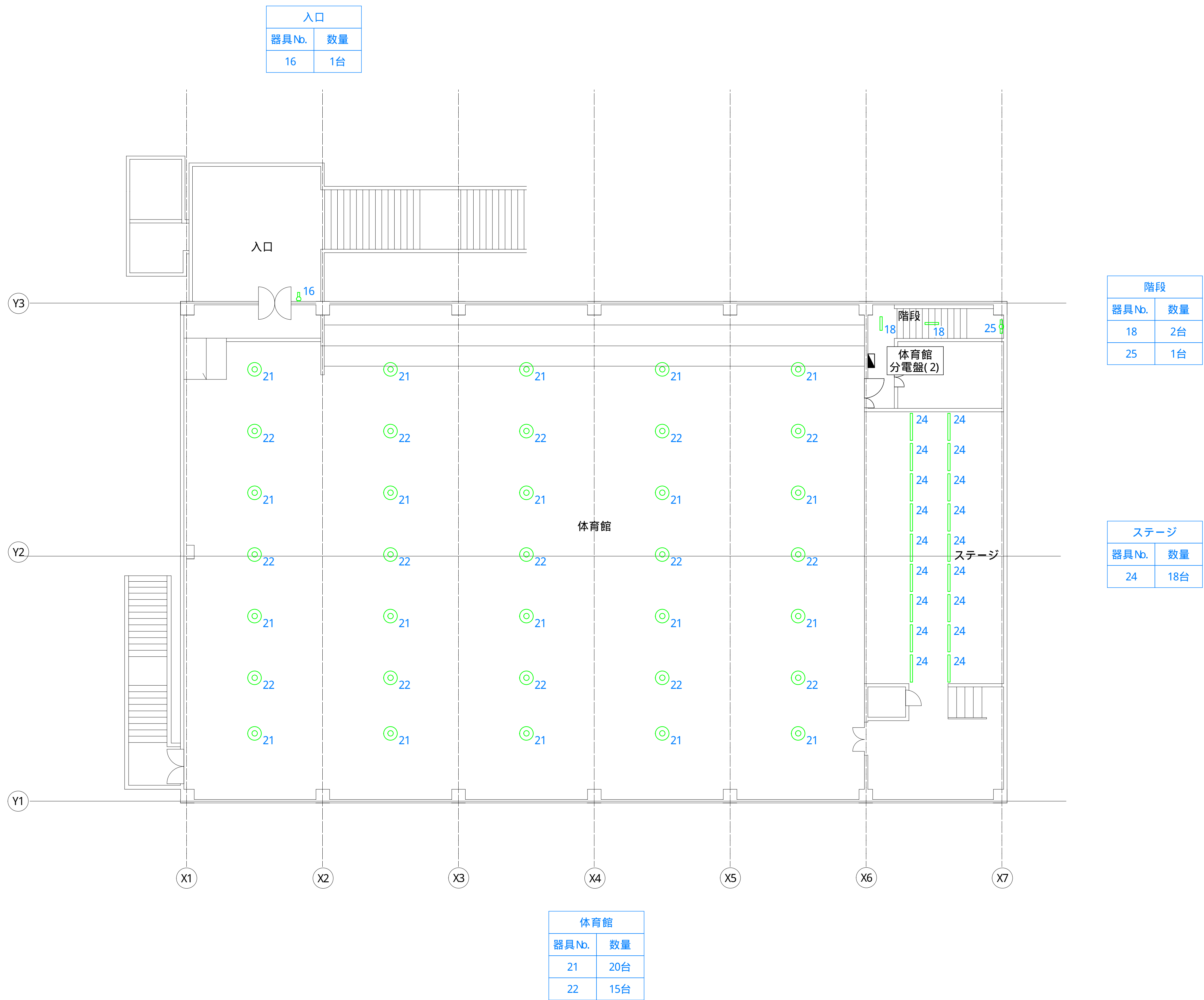
【図面11-09-9】 電気設備位置図 (照明関係)
