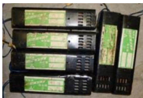
P C B 廃棄物の例（蛍光灯安定器）
