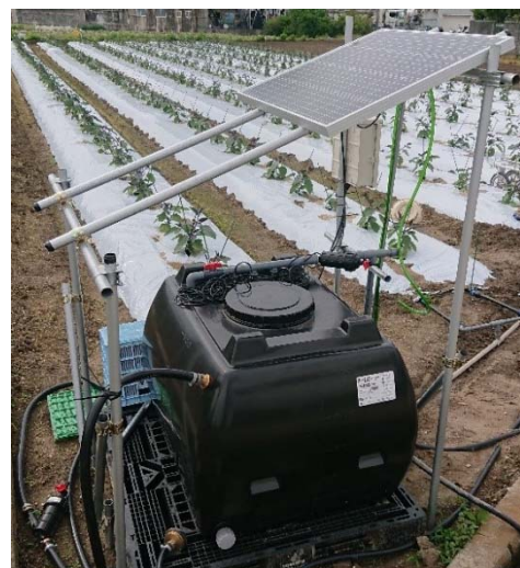
太陽光発電による自動かん水装置
