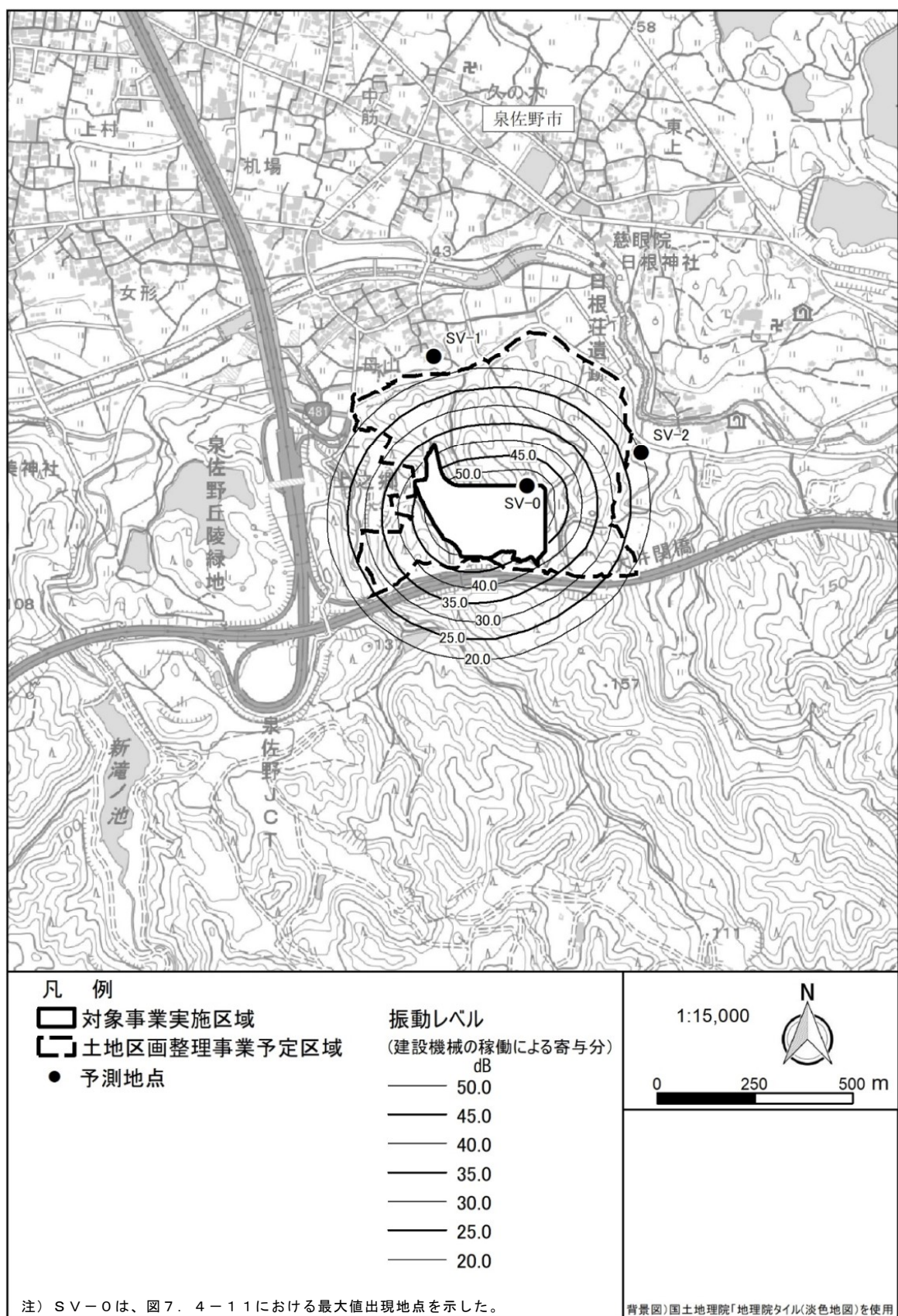
図 7. 4 - 1 2 建設機械の稼働による振動の予測結果（周辺の保全対象）
