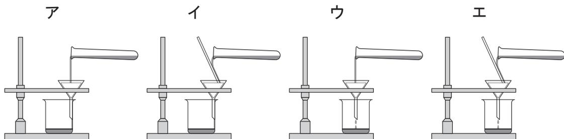
アとイは、ろうとのあしの先端(切り口の長い方)がビーカーの内壁ないへきに接しているが、ウとエは接していない。
