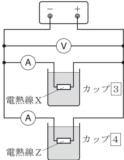
電熱線Xと電熱線Zは、図4の回路では直列に、図5の回路では並列につながれています。また、次の【表】はこの実験を行った場合に結果として考えられるデータをまとめたもので、【表】中の $I_1 \sim I_4$ は、各電熱線に流れる電流の大きさを、 $T_1 \sim T_4$ は、5分間電流を流した後の各カップ内の水の温度を表しています。①、②の問いに答えなさい。
