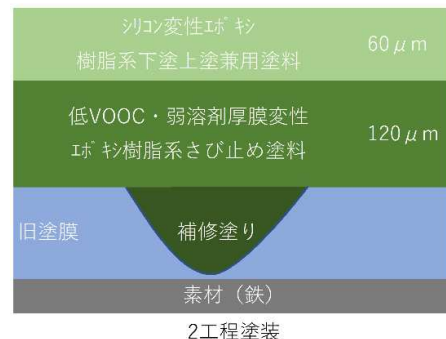
図 3.9-24 効率化とコスト縮減：省工程塗装
