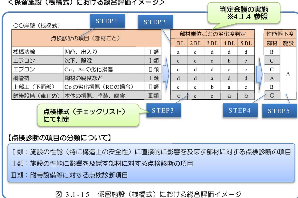
図 3.1 - 15 係留施設（棧橋式）における総合評価イメージ
