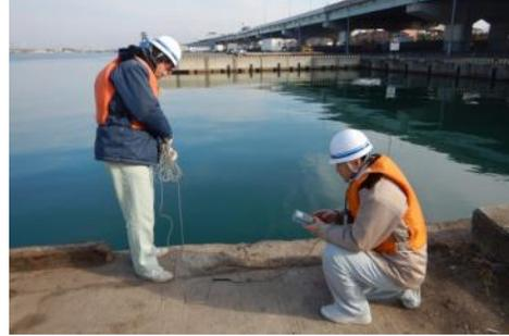
係留施設の鋼矢板（電位測定）
