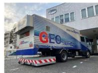
スクリーニング用の路面下空洞探査車
