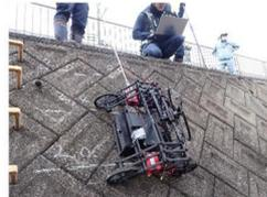
←探査機が護岸（2段目）を水平方向に進行している様子
