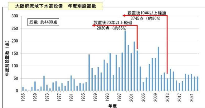
図 3.2-1 下水道施設の高齢化状況
