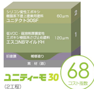
図 3.9-21 効率化とコスト縮減：省工程塗装
