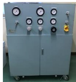
水素充填システム
