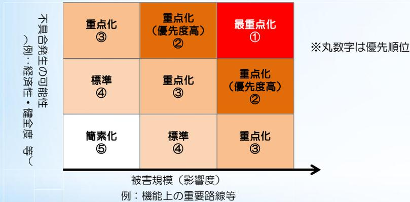
図4.3 リスクマトリックスによる優先順位付けの例（管渠の場合）
