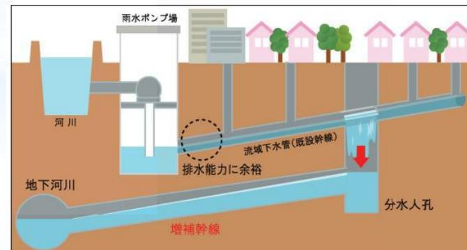
増補幹線ができると雨水ポンプ場・下水道の排水能力を超える雨水を途中で増補幹線に落とすため、浸水発生の可能性を低く抑えることができます。
