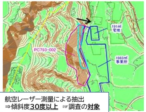
急傾斜地の基準：がけ高さ5m以上 傾斜度30度以上
