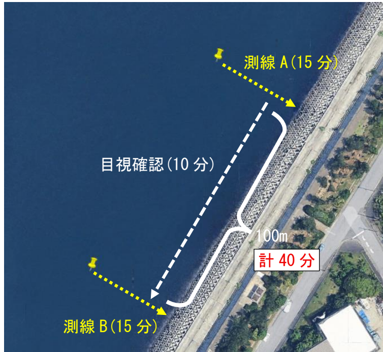
図 4.2-47(2) 潜水目視手法 2 のモデルイメージ(100m 区間)
