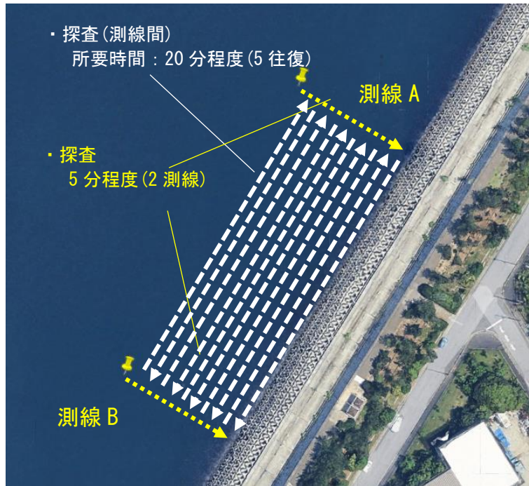
図 4.2-49 (1) 音響探査の実績イメージ (観察位置および所要時間)
