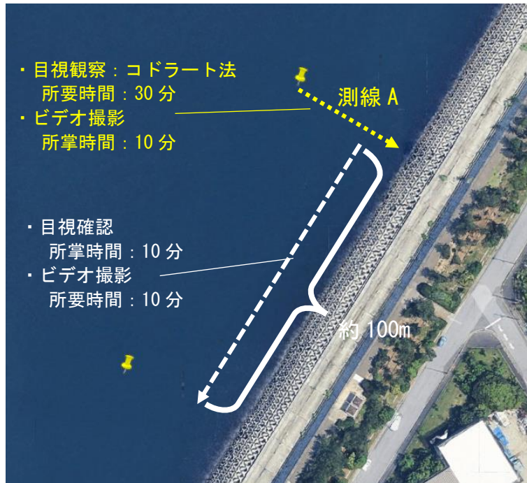
図 4.2-46(1) 潜水目視手法 1 の実績イメージ(観察位置および所要時間)
