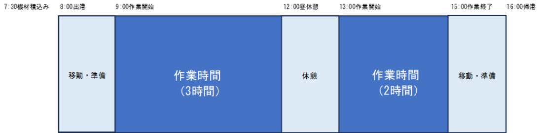
図 4.2-45 1日の作業工程(例)
