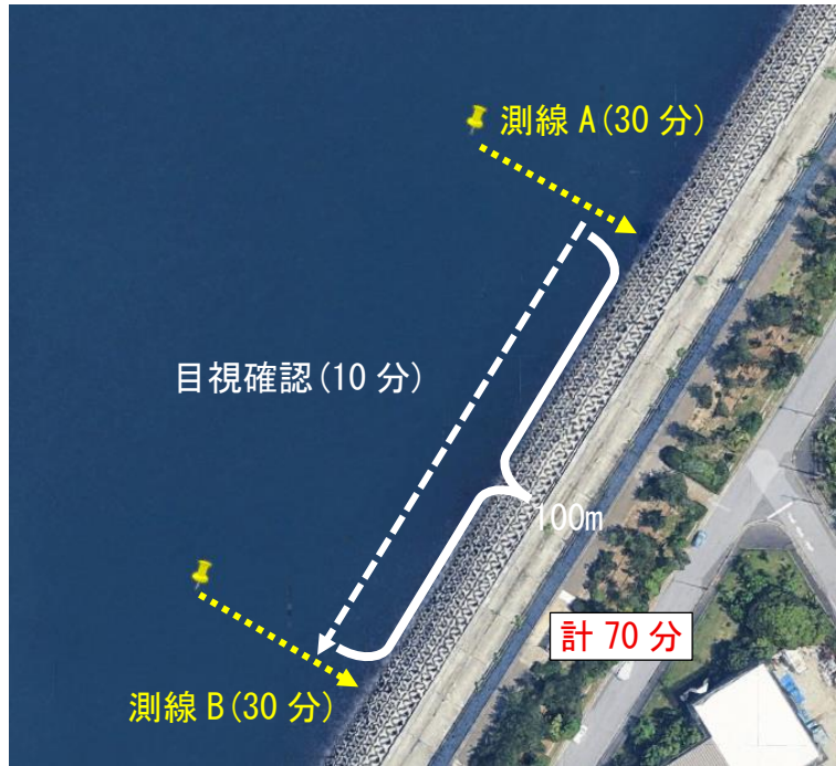
図 4.2-46(2) 潜水目視手法 1 のモデルイメージ(100m 区間)
