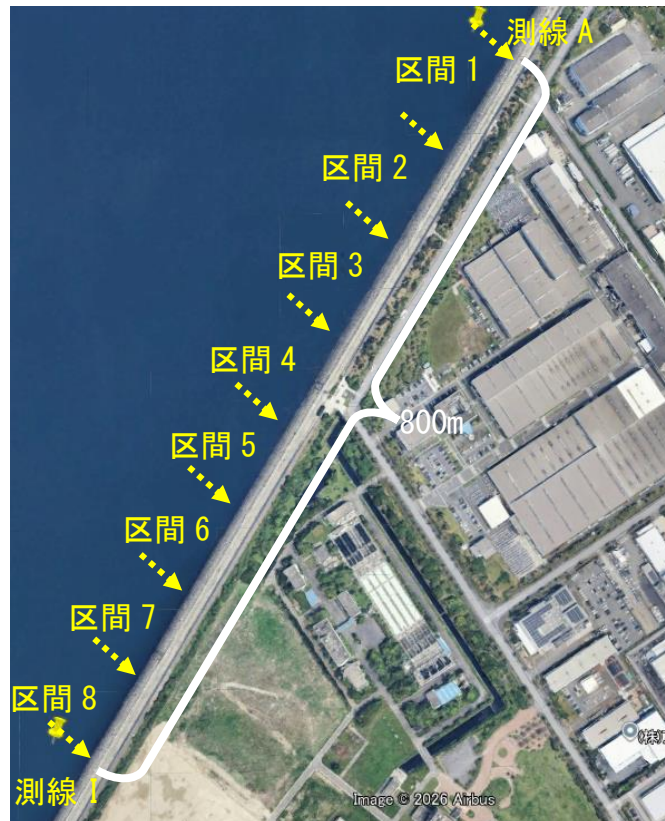
図 4. 2-49 (3) 音響探査の 1 日に可能な作業区間範囲のイメージ
