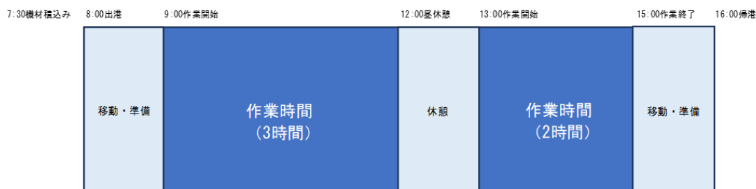
図 4.2-45 1日の作業工程(例)
