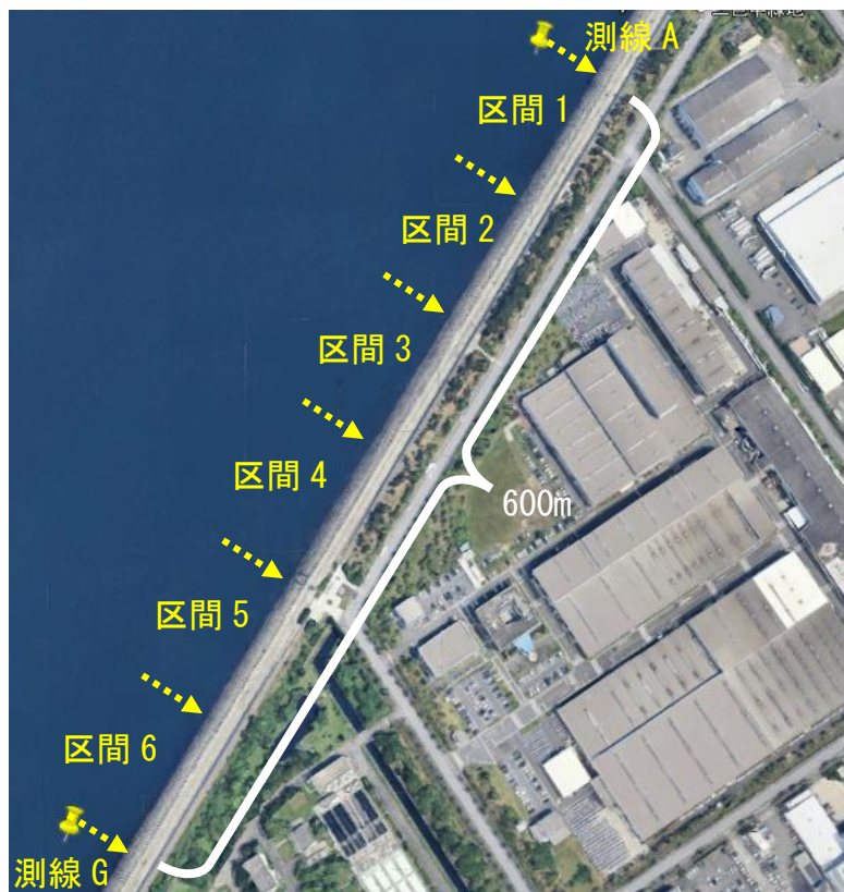
図 4.2-46(3) 潜水目視手法 1 の 1 日に可能な作業区間範囲イメージ
