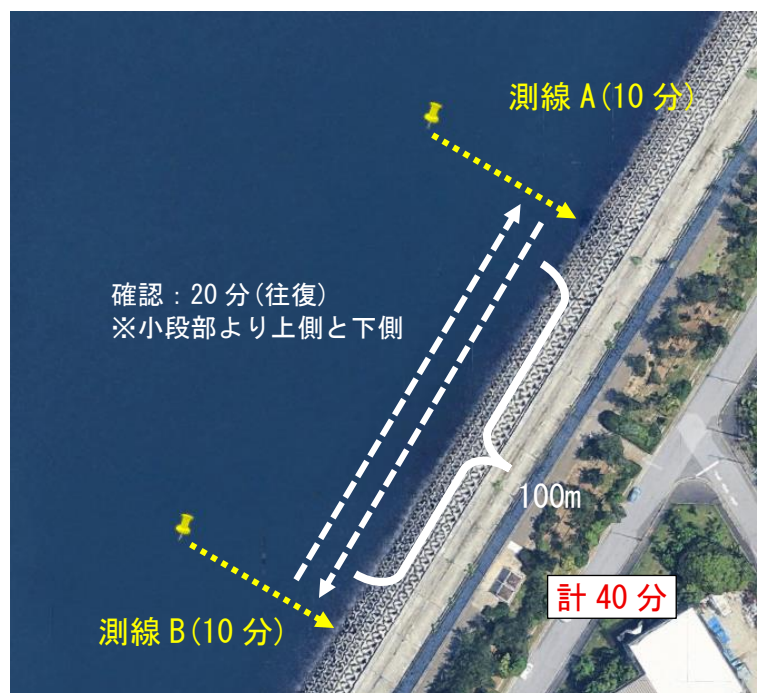
図 4.2-48 (2) 水中ドローンのモデルイメージ(100m 区間)
