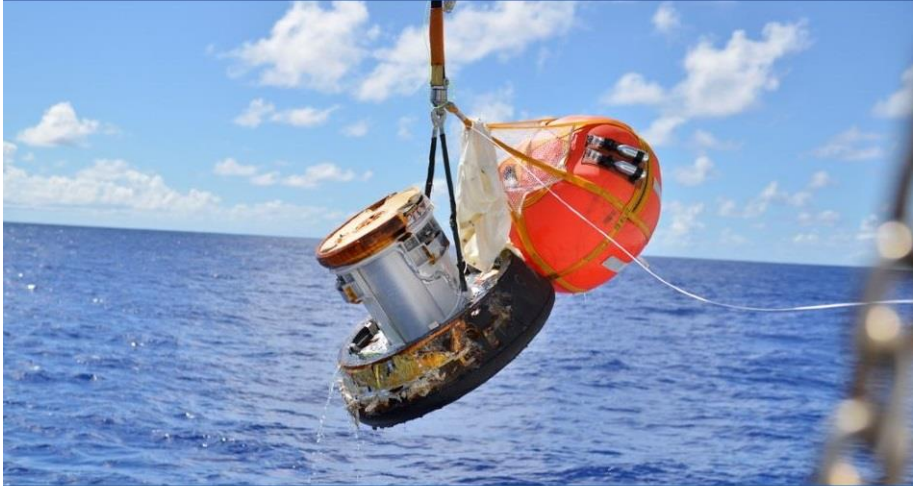
真空断熱容器を搭載したJAXAの回収カプセル
