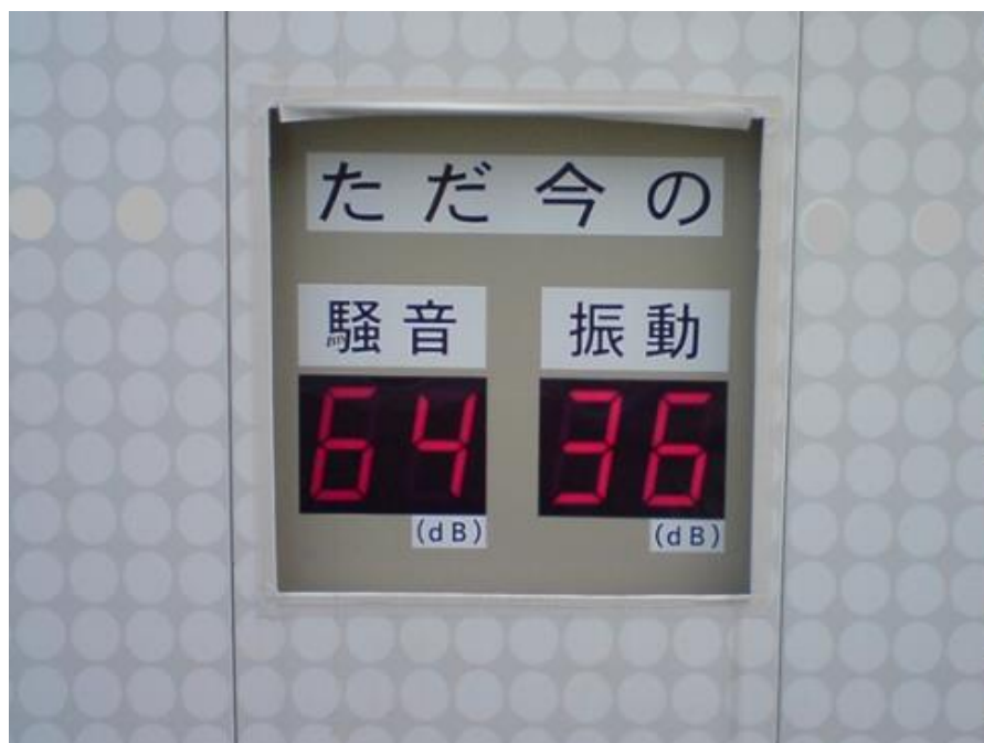
発進基地敷地境界における測定
