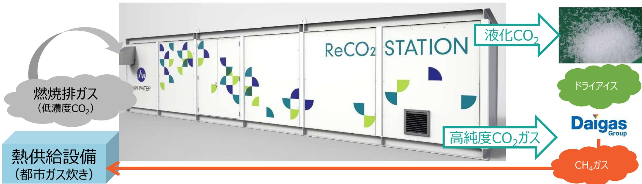
①新規CO<sub>2</sub>回収材Na-Fe系酸化物を用いた高効率CO<sub>2</sub>回収実証
