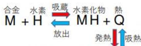
※水素吸蔵合金は、金属の結晶中に水素を取り込み金属水素化合物になることで、液化水素と同等以上の体積密度で水素を貯蔵できる。
