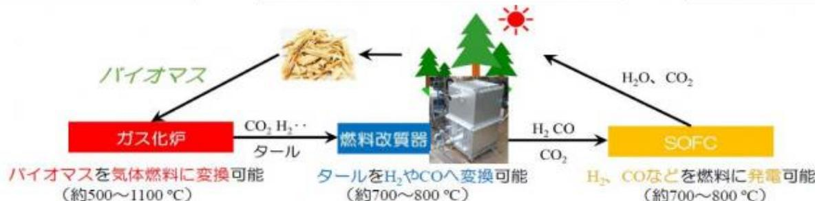
加熱により容易に再生できる触媒を適用し、メンテナンスフリーのシステムを構築
