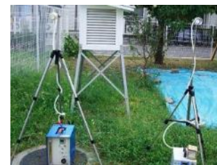
大気中の石綿濃度測定
