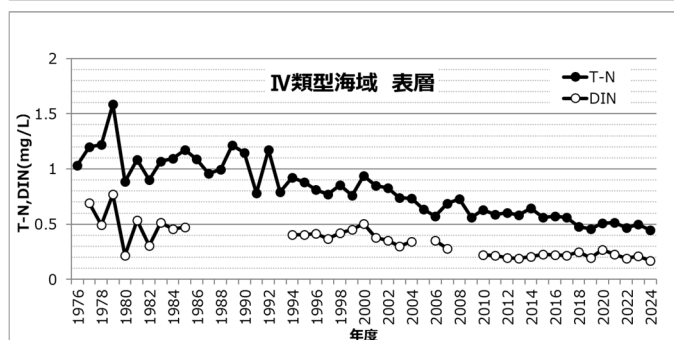
図 14 表層の全窒素(T-N)及び溶溶性無機態窒素(DIN)の年平均値 (mg/L) の経年変化 (大阪府が測定する環境基準点におけるデータ)
