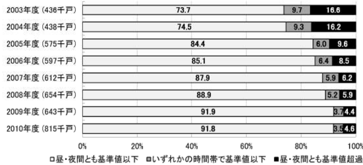
【道路に面する地域における環境騒音に係る環境保全目標達成率の推移】
