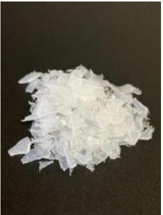
②保水容器PE 材料が確保が不十分だったため、造粒を行わずダンベル片を成形。
