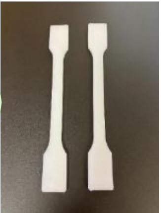
②保水容器PE 材料が確保が不十分だったため、造粒を行わずダンベル片を成形。
