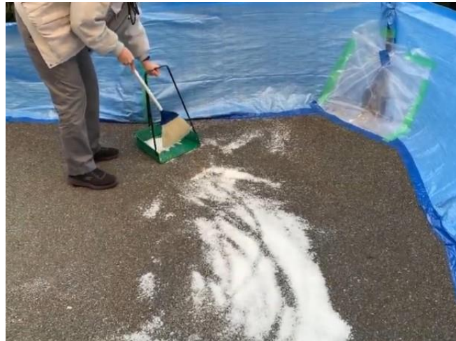
箒・塵取りで路上に流出したビーズを回収する実験の様子
