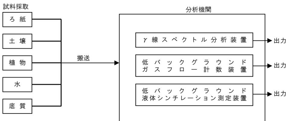
図2 試料採取・測定装置フロー図
