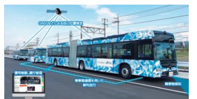
自動運転・隊列走行BRT社会実験 出典:JR西日本HP
