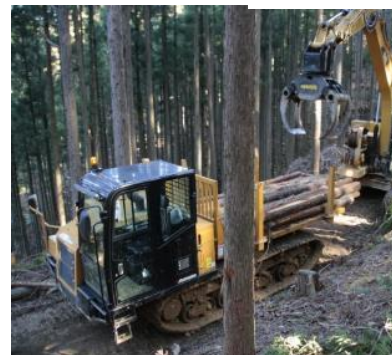
遠隔操作の運搬機械
