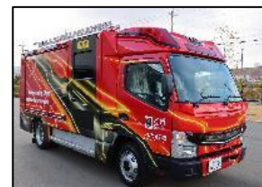
EVポンプ消防自動車
