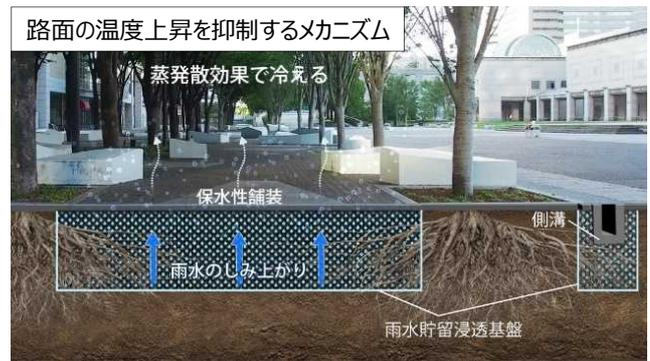
路面の温度上昇を抑制するメカニズム
