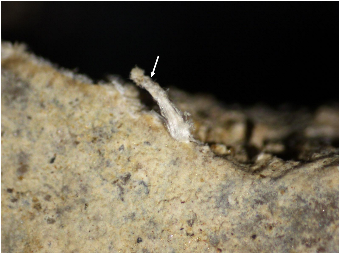
セメント板の実体顕微鏡写真。矢印はクリソタイル（白石綿）繊維束。
