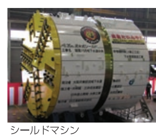
シルドマシン（この機械で地中に増補幹線を敷設します）
