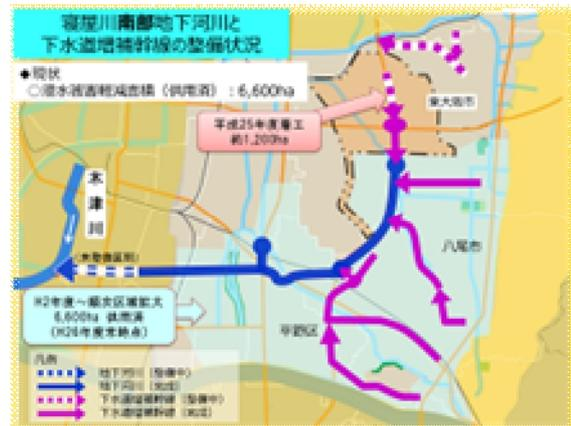
寝屋川南部流域については、飛行場南増補幹線ほか5幹線を南部地下河川に接続し、平成23年6月から下水道と河川で一体供用を行っている。
