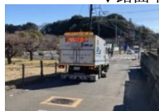
（空洞探査車による調査）
