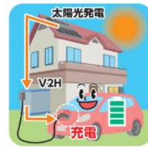
V2H：自動車に蓄えた電気を家庭で使う仕組み
