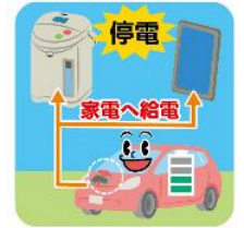
V2H：自動車に蓄えた電気を家庭で使う仕組み
