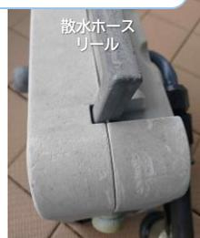
屋外で使われるプラスチック製品は紫外線などの影響で劣化しボロボロにくだけてしまう
