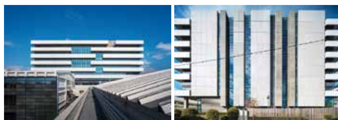
南北面：水平バルコニーによる庇効果とウェルネスの両立 東西面：開口部を縦長に絞り、角度と高度の低い日射を抑制
