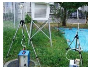
大気中の石綿濃度測定
