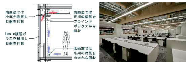
簡易エアフローシステム断面
