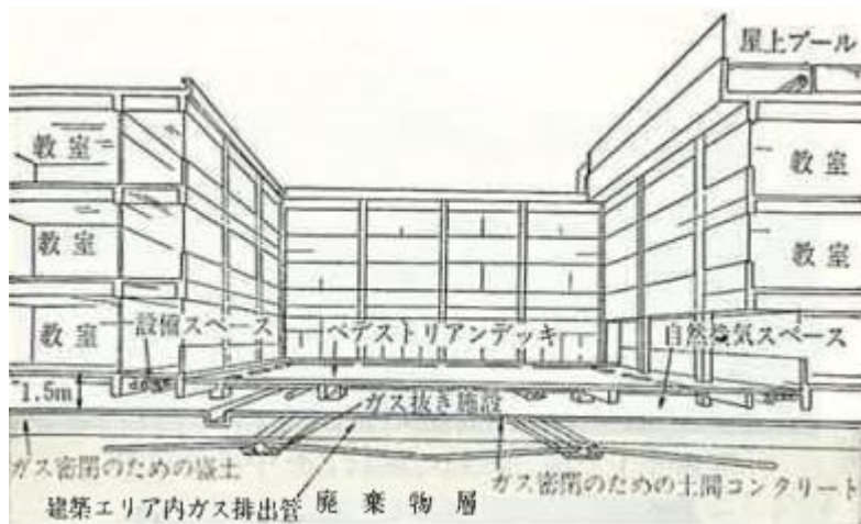
図6 学校建設における対策事例(福岡市)
