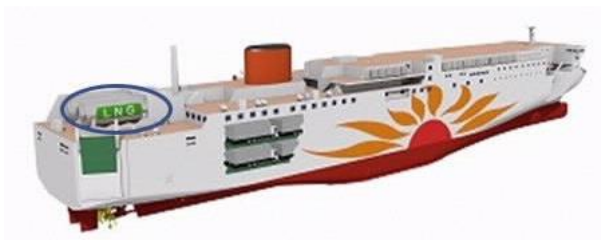
【LNG燃料フェリーのイメージ図（株式会社商船三井ホームページより）】
