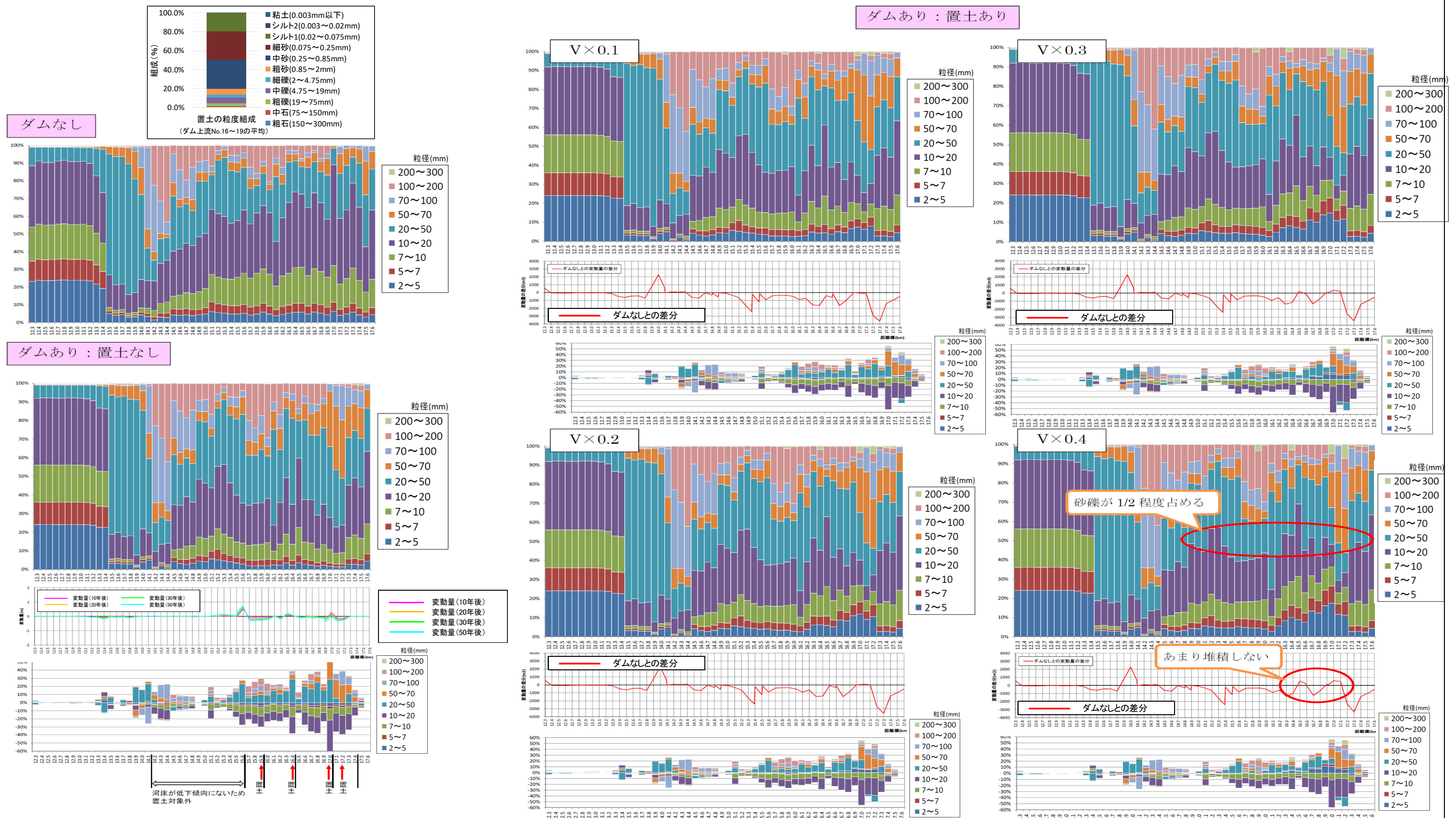
図 3-8 砂礫河床を好む生物への影響軽減を主眼とした土砂還元を実施した場合の河床変動計算結果（4 箇所に年平均低下量 (V=400m 3 ) の 0.1~0.4 倍置土を実施した場合） ※置土土砂の粒径は、置土採取位置の堆砂土砂の 10 年平均相当の粒度分布 出典：「第 5 回 環境改善放流検討部会資料」（H28.1.22）
