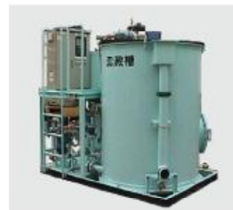
濁水処理施設 (大岩地区建設発生土受入地)
