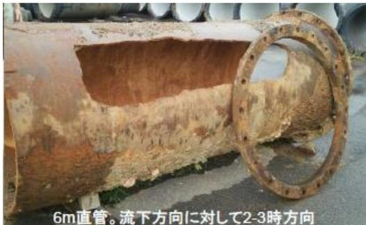
6m直管。流下方向に対して2-3時方向
