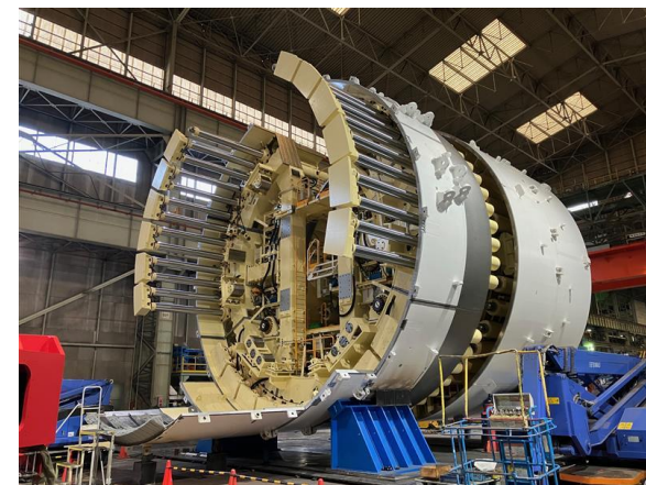
シールドマシン製作状況
