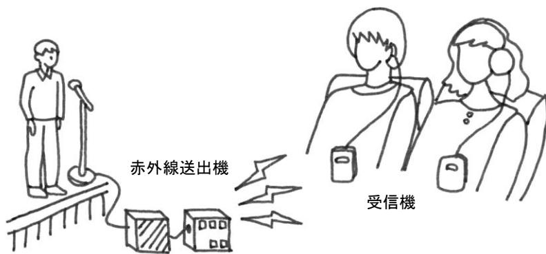
※赤外線補聴装置とは、対象エリアに赤外線送出機を設置し、受信機で受信する。広いエリアの場合は、3種類（10m、30m、45m）の送出機を単独又は組み合わせて配置する。ヘッドホン又は補聴器で受信する。
