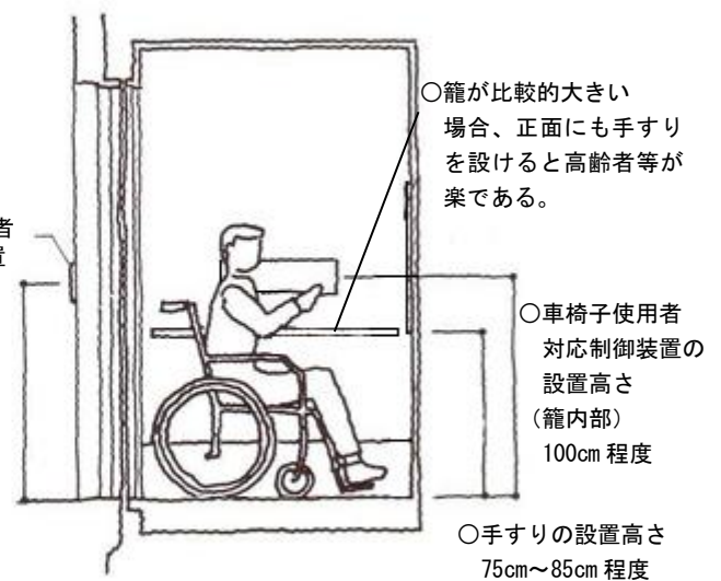
○図 6.4 手すりや制御装置の高さ
