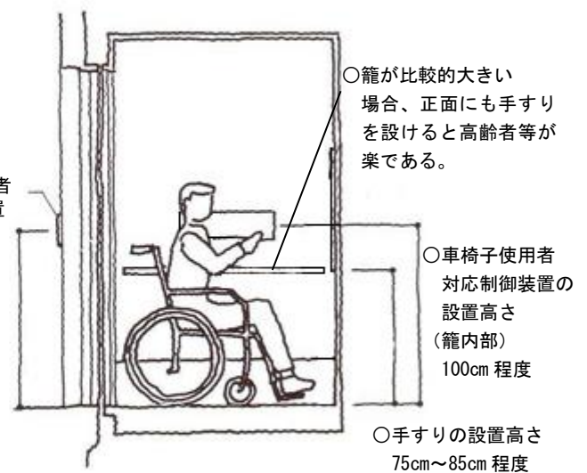
○図 6.4 手すりや制御装置の高さ
