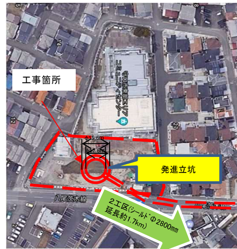
門真守口増補幹線（第2工区）下水管渠築造工事 発進立坑写真
